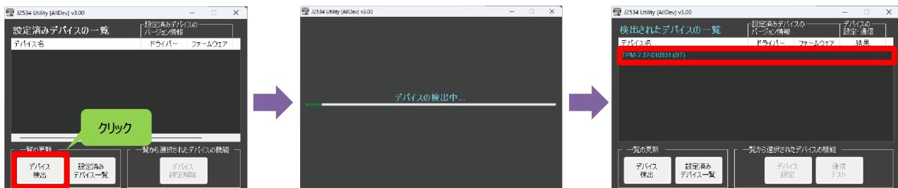
(4) 一覧に表示された接続したデバイス（機種名\_XX-XXXXXX(接続方式)）と、本体のシリアル番号が一致していることを確認したのちに、デバイス名をクリックします。
