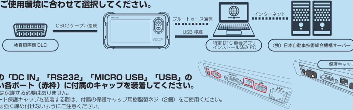
本体上部の「DC IN」「RS232」「MICRO USB」「USB」の使用しない各ポート（赤枠に付属のキャップを装着してください）。
