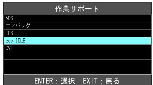
9. 『eco IDLE 作業サポート』画面が表示されますので、**〔スタータ作動回数の確認〕** を選択して [ENTER] をタップします。
