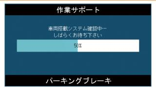
作業サポート 4. 『作業サポート』画面が表示されましたら、 車体番号読取 〔オートライト&ワイパー〕 を選択して ABS/VDC バーキングブレーキ [ENTER] をタップします。 アイドリングストップ オートライト&ワイパー ENTER:選択 EXIT:戻る オートライト&ワイパー作業サポート 5. 『オートライト&ワイパー作業サポート』画面で センサ初期設定 〔センサ初期設定〕 を選択して、[ENTER] をタッ プします。 ENTER; 選択 EXIT: 戻る センサ初期設定 6. 初期設定の確認画面が表示されますので、 [ENTER] をタップします。 センサの初期化を行います。 ENTER: 実行 EXIT:中止 センサ初期設定 7. 初期化が開始されます。 イニシャライズ中… しばらくお待ち下さい センサ初期設定 8. 正常終了のメッセージが表示されましたら、作業 完了です。 正常終了 ENTER/EXIT:終了
