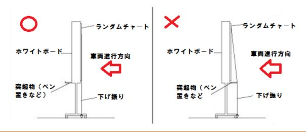
照明はランダムチャートの上方から当てチャート内が均一の明るさになる様調整して下さい。 ランダムチャートに光が反射する位置からライトを照射した場合は、反射光がカメラに入って しまい正しく調整する事が出来ません。
