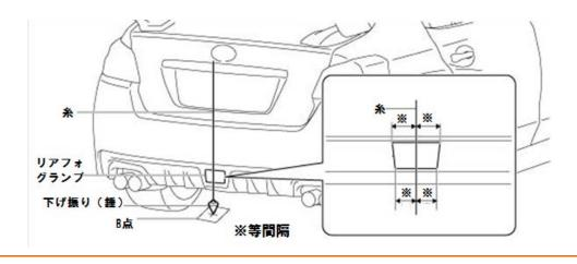
マーキングした B 点から A 点を通り、車両前方に向かい 5m以上まで糸を張りテープ等で固定して下さい。(以降 A-B 線)
