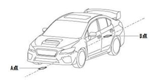
左右前輪タイヤ中心から垂直に下げ振りを下ろし C 点及び D 点をマーキングして下さい。 車両中心線(A-B 線)に対して平行になる様に C 点及び D 点を起点に車両前方 C 4mへ糸を張り C 点をマーキングし C 点と C 点を通る様に糸を張って下さい。(以降 C に解)
