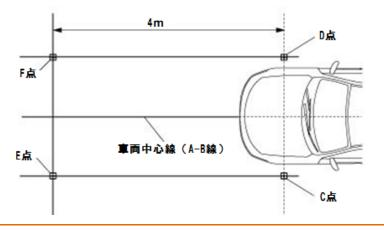
下図設定位置へランダムチャートをホワイトボード等に張り付けて下さい。張り付ける際はチャートの端から 10mm 以内に光沢の無いテープ等で固定して下さい。
