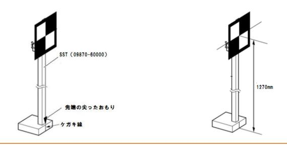
車両前後のエンブレム中心から先端のとがったおもりを垂直に垂らしマーキングして下さい。車両後部を A 点、車両前部を B 点とします。
