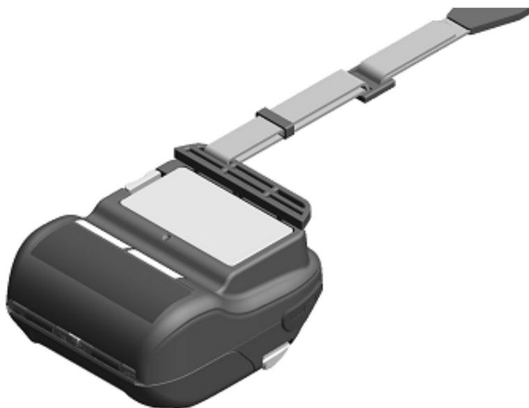
図 13-8 ショルダストラップの取り付け(4)
