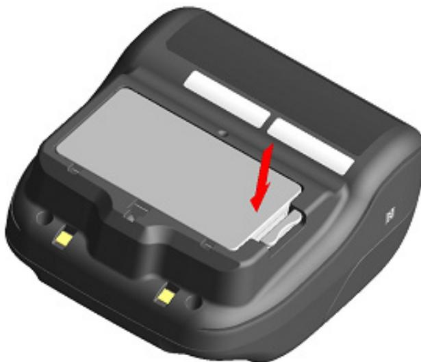
図 8-3 バッテリーパックの取り付け(2)
