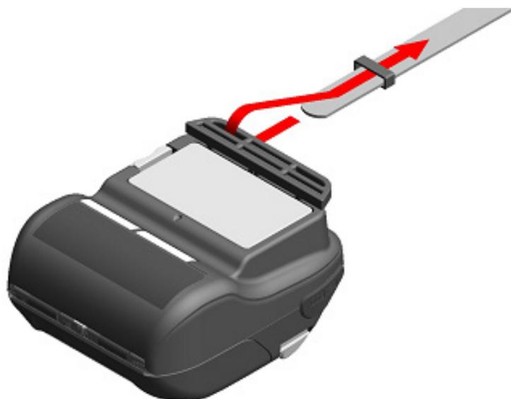
図 13-7 ショルダストラップの取り付け(3)
