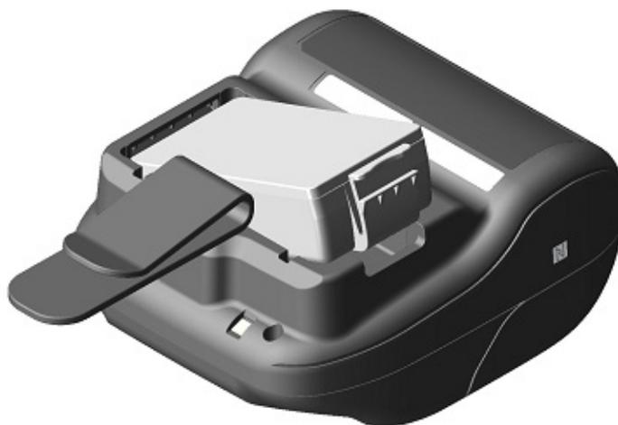
図 13-3 ベルトクリップの取り付け(3)
