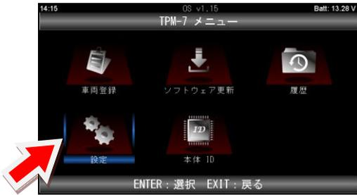
2. 設定画面が表示されます。上下矢印ボタンで設定する項目を選択して[ENTER]ボタンを押します。
