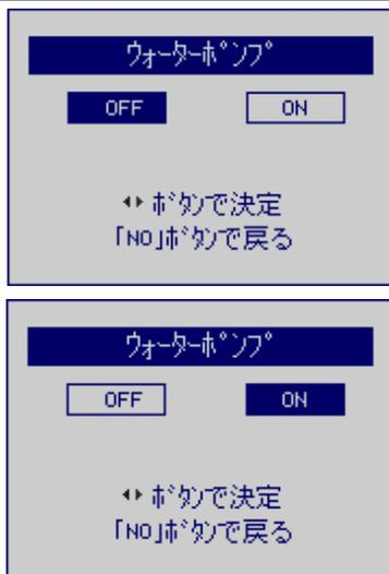
**基準：3 回程度作業を繰返し、「ウォーターポンプの作動音が小さくなる」および「インバータリザーブタンクから覗いて気泡が出なくなる」の状態になれば、冷却水のエア抜きは完了です。**
